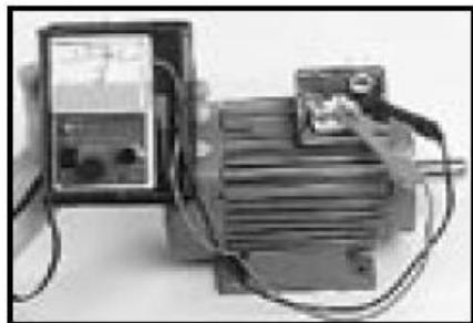
Mätning kan utföras på respektive Y-eller D-kopplad motor. Mätex. enl. nedan illustrerar 3 st. olika elmotorer A,B och C Stator lindning mäts direkt på motorkopplings-splint. Sätt testladdarna enligt nedanstående bilder och jämför faslindningarna mot varandra mätvärdena skall vara näst intill lika
