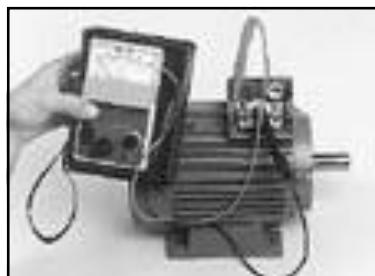
Anslut svart testsladd till objektets hölje (jordpunkt), röd testsladd till ett lindningsuttag, kopplingsplint el. dyl. Isolationstest kan göras direkt i startutrustning, motorstickpropp el. dyl. Vidrör ej testsladdar, bananstift, eller krokodilklämmor. Tryck på röd tryckknapp 500VDC. Avläs mätinstrumentet - röd skala graderad i MΩ. Om isolationsvärdet är lågt, bör objektet demonteras, rengöras, torkas eller eventuellt lindas om.
