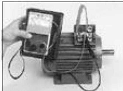
Tilslut den sorte prøveledning til objektets stel (jordpunktet) og tilslut så den røde prøveledning til en terminal, et udtag eller lignede. Isolationstesten kan udføres direkte i starteren, CEE stikproppe eller lignede. Berør ikke prøveledningerne, krokodillenæb eller motoren. Tryk på den røde trykknap 500V. Aflæs måleinstrumentet – den røde skala er inddelt i MΩ. Hvis isolationsværdien er lav, bør objektet demonteres, rengøres, tørres eller eventuelt vikles om.
