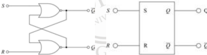
Slika 11.12. SR leč kolo sa NILI kolima i grafički simbol SR leča.
