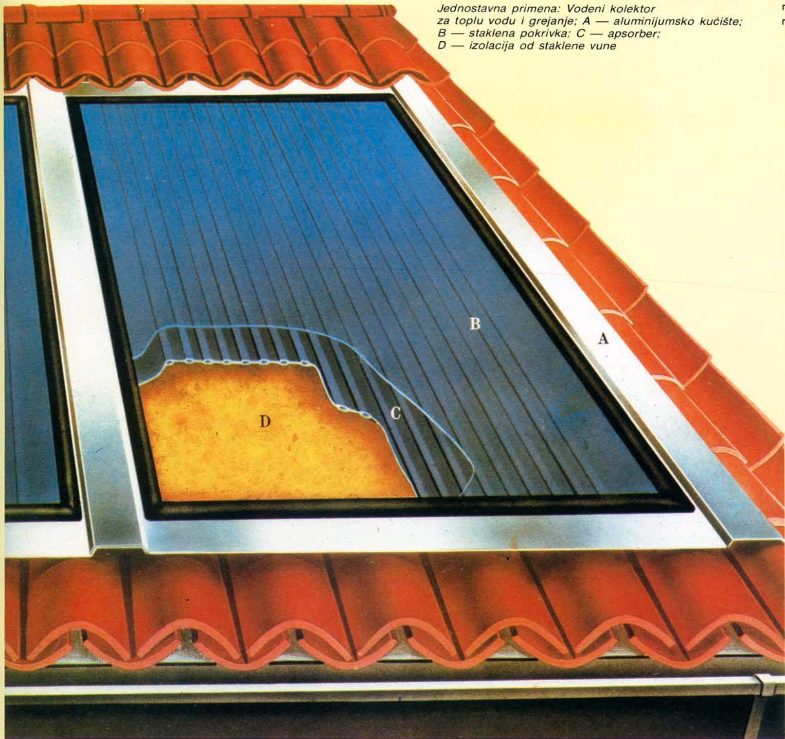
Sunčev zračenje se lako apsorbuje u raznim materijalima i pri tome se njegova energija najvećim delom pretvara u toplotu. Uredaj u kome se to ostvaruje naziva se prijemnik (kolektor) sunčeve energije. Prema konstrukciji i načinu rada, razlikujemo dve osnovne vrste prijemnika: ravne i fokusirajuće. Prvi postiže temperaturu do 100°C, a drugi, zahvaljujući koncentrisanju sunčevog zračenja pomoću optičkih sistema, čak do 3500 K. Međutim, ti prijemnici zahtevaju stalno usmeravanje prema suncu.
