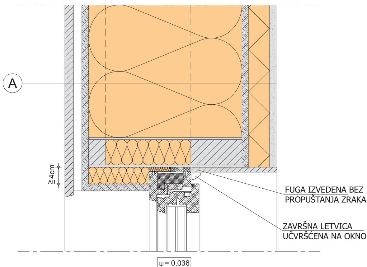
Kod izolacije okna obratiti pažnju na smjernice za ugradnju proizvođača prozora
