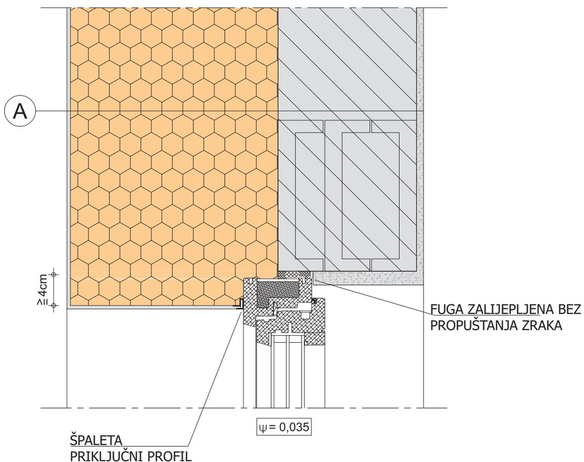
Kod izolacije okna obratiti pažnju na smjernice za ugradnju proizvođača prozora
