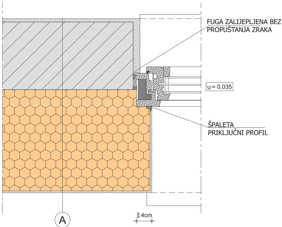
Kod izolacije okna obratiti pažnju na smjernice za ugradnju proizvođača prozora
