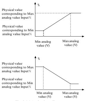
Fig. 5-4-1 Analog input linear curve
