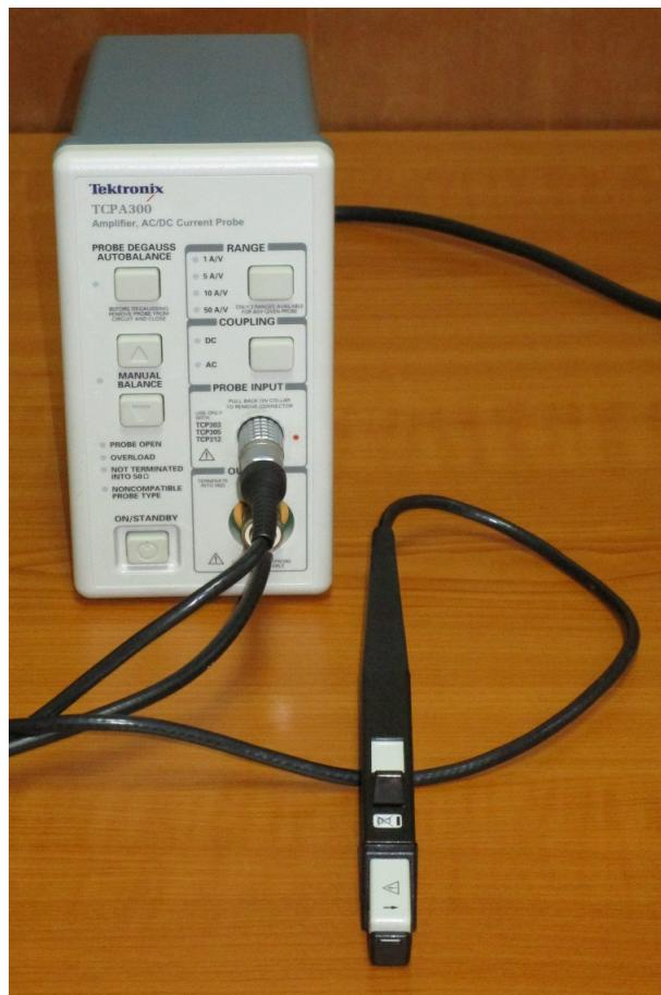
Slika 3.11: Strujna sonda sa širokim propusnim opsegom.
