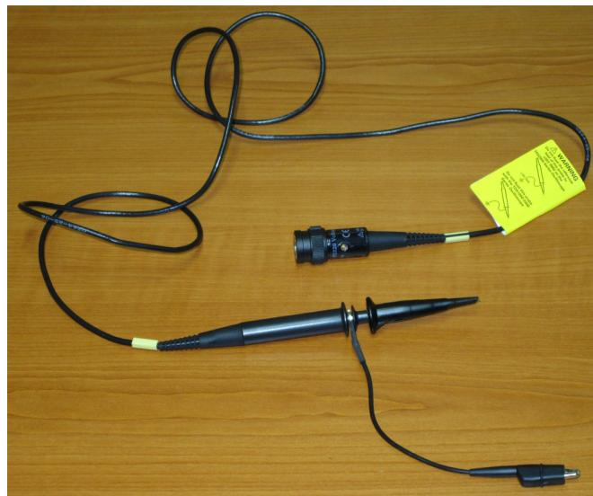
Slika 3.1: Naponska sonda, 1 : 1 i 10 : 1, sa priključkom za masu.
