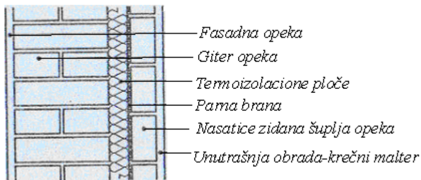
Slika 3.10. Presek konstrukcije "sendvič" zida sa šupljom opekom.
