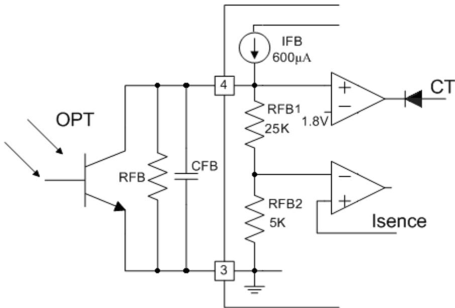
图 3: 反馈与控制电路图
