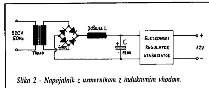
Slika 2 - Napajalnik z usmernikom z induktivnim vhodom.
