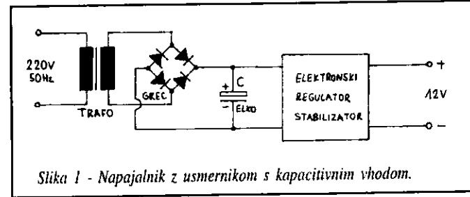
Slika 1 - Napajalnik z usmernikom s kapacitivnim vhodom.
