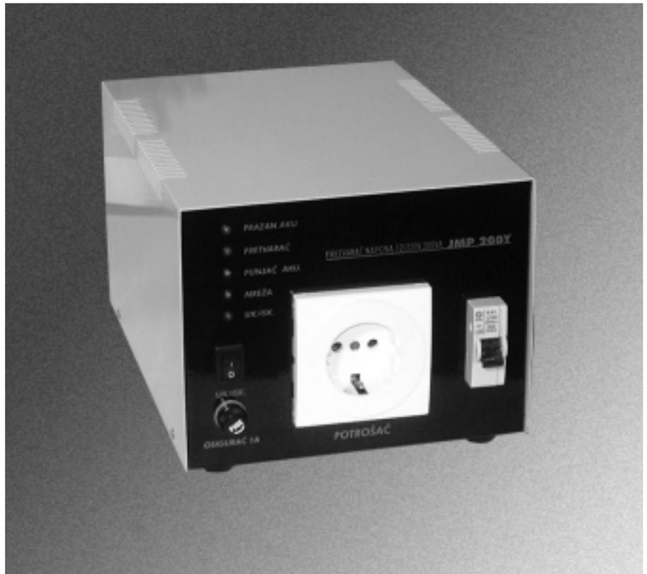
Umesto gomile hardvera upotrebljeno je jedno jedino integrisano kolo, mikrokontroler AT89C2051 i par elemenata oko njega. Naravno, potreban je i softver koji kontroliše rad celog pretvarača/punjača akumulatora (dostupan kod autora projekta).
