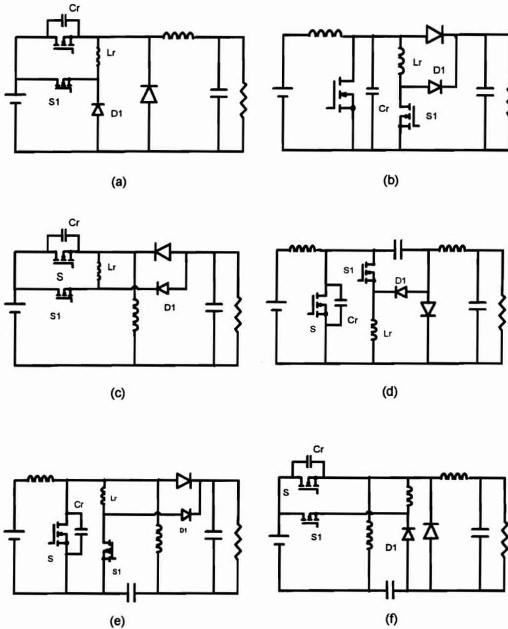
**Fig. 4.11. Six basic topologies of the ZVT-PWM converters: (a) buck, (b) boost, (c) buck-boost, (d) Cuk, (e) Sepic, and (f) Zeta.**
