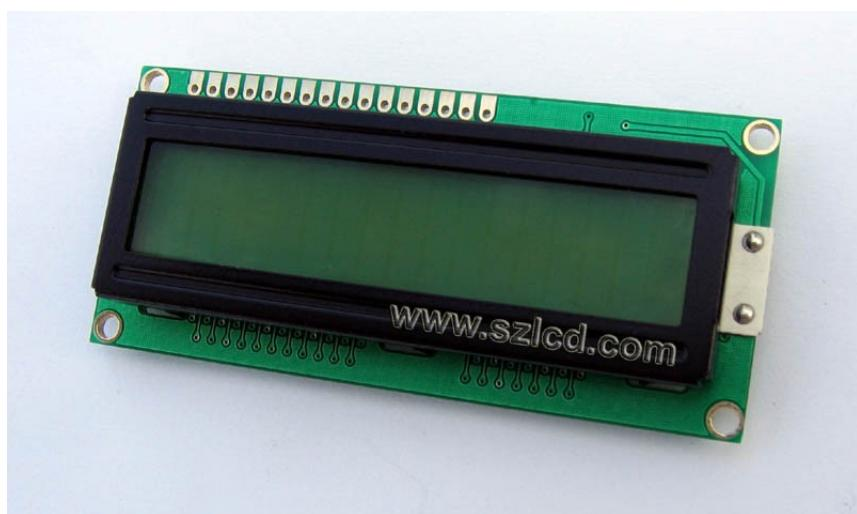
to bi bio primjer jednog paralelnog 16x2 LCD-a, još postoji i
