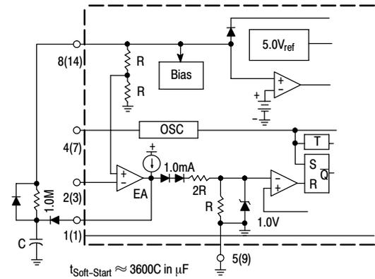
**Figure 21. Soft-Start Circuit**
