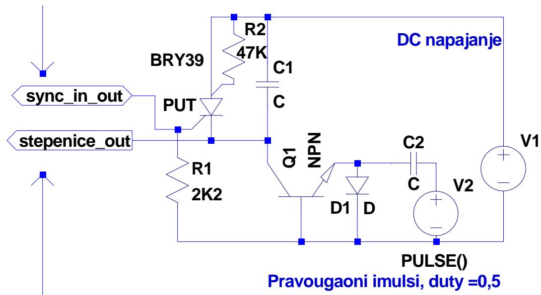
**Signal silazne stepenice, od Vcc do - 0,7V. Broj stepenica=Vcc/Vpulse x C1/C2**
