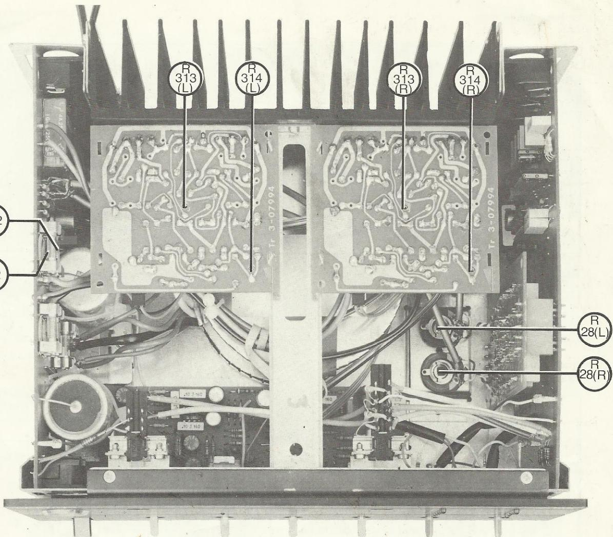
Für Servicezwecke ist das Endstufenkühlblech mit beiden Treiberplatinen nach hinten ausklappbar.
