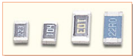
Bild 1: SMD-Widerstände in unterschiedlichen Größen (0805 und 1206).
