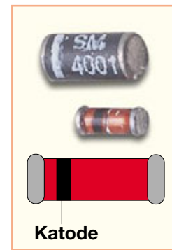
Bild 6: Standard bei Universaldioden - das MELF-Gehäuse
