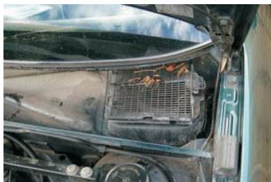
Pre svega treba ukloniti dve maticе zavrtnja prečnika 10 mm, a gornji deo poklopca treba odvojiti. Ispod njega nalazi se plastični zaptivač koji treba pažljivo odvojiti. Tako ostaju samo 2 vijke pričvršćena maticama prečnika 8 mm koji prolaze kroz pregradu i ulaze u gornji deo ventilatora. Ako imate klimu, videćete i mali bosch motor koji služi za recalculating poklopca, koji može da onemogući pristup.
