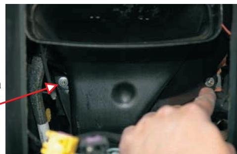
Ti zavrtnji su pričvršćeni za kućište matrice. Zavrtanj sa vaše desne strane je spojen sa ljubičasto-braon multiplug konektorom koji pripada sistemu žica ventilatora i ne morate ga pomerati. Iza ovog priključka nalazi se još kanala koji dolaze od instrument table.
