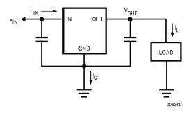
**FIGURE 4. Power Dissipation Diagram**
