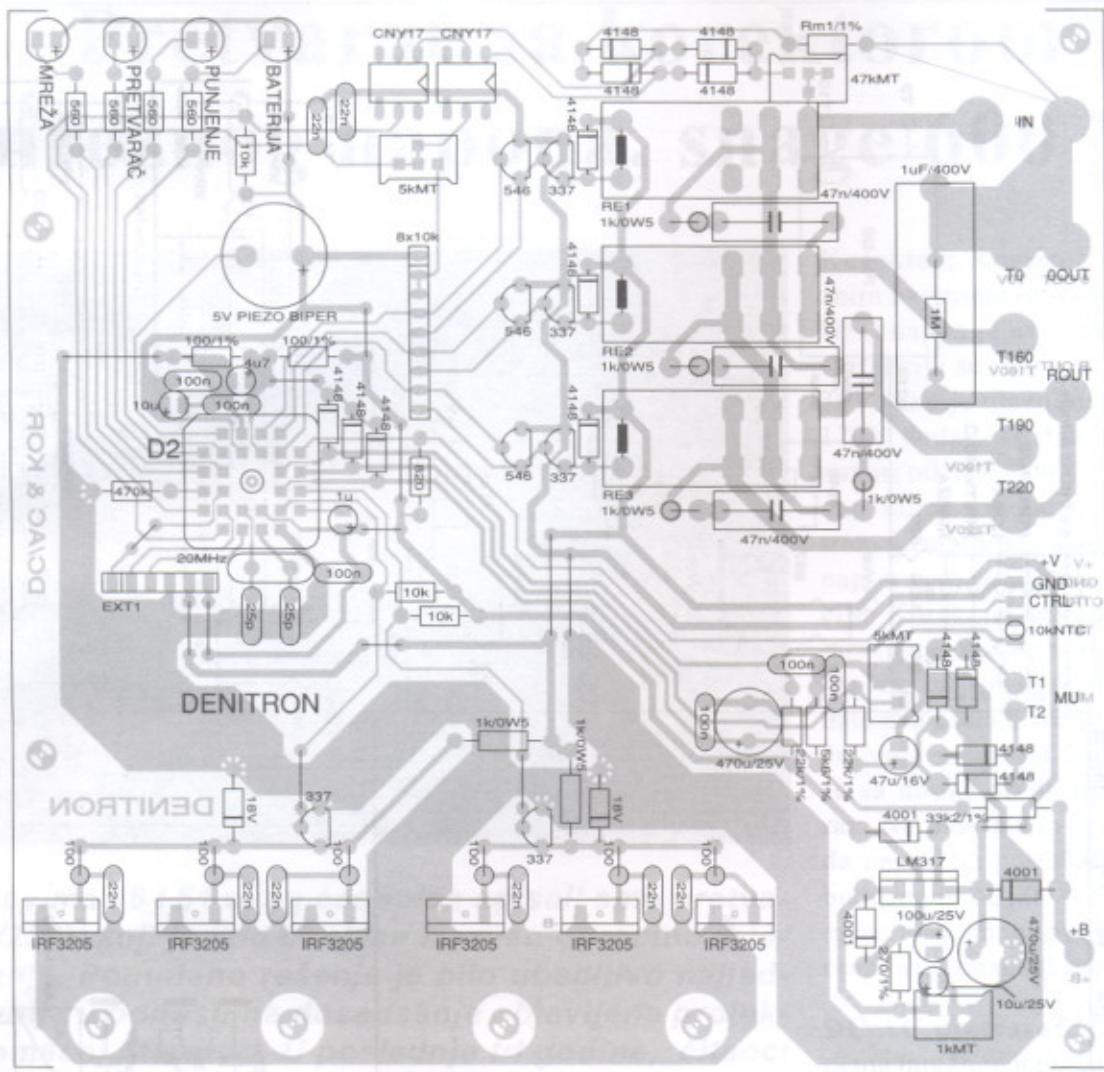
Raspored elemenata na osnovnoj ploči
