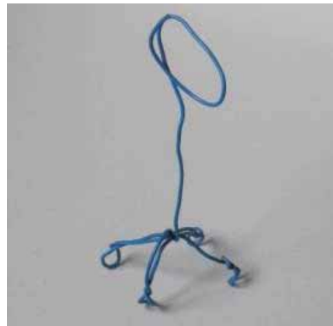
10. Pomagalo - držač pločice u mediju za nagrizanje (izolirana bakrena žica 1,5 - 2,5mm 2 )
