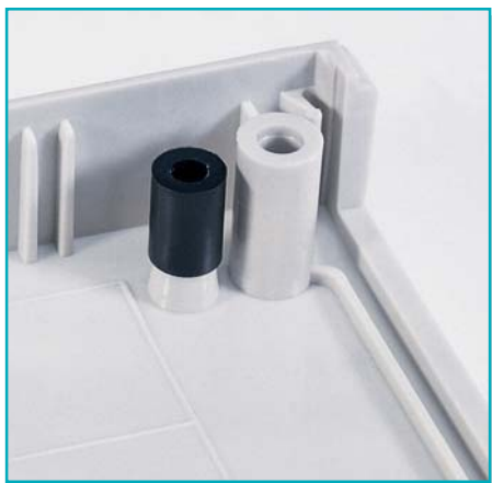
Bild 8: So erfolgt das Einkleben der Distanzrollen
